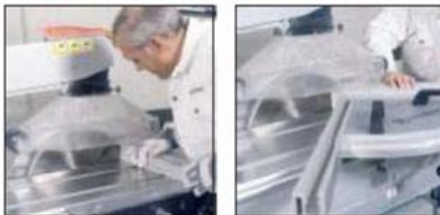
Obr. 32 - Krácení okružní pilou
