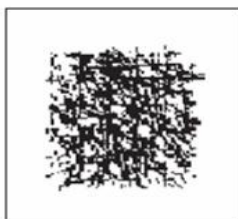
kontinuální rohož náhodná orientace vláken
